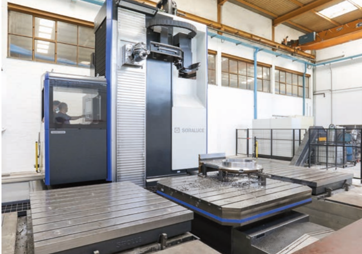
Sopra: la fresatrice a montante mobile Soraluce FS 6.000 recentemente installata presso Ferro Bac
